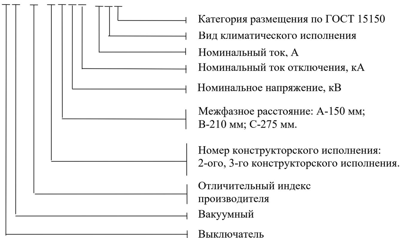
Пример записи условного обозначения выключателя вакуумного 2-ого конструкторского исполнения с межполюсным расстоянием 210 мм на напряжение 10 кВ, номинальный ток отключения 25 кА, номинальный ток 1250 А, для климатического исполнения и категории размещения У3, при заказе и в технической документации:
