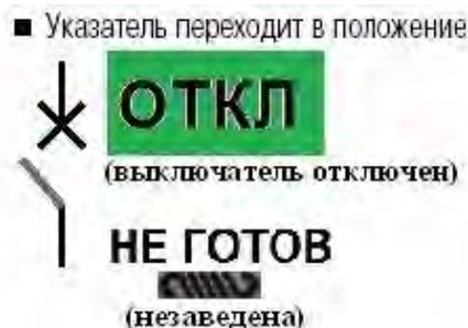
Рисунок 6 – Отключение выключателя
